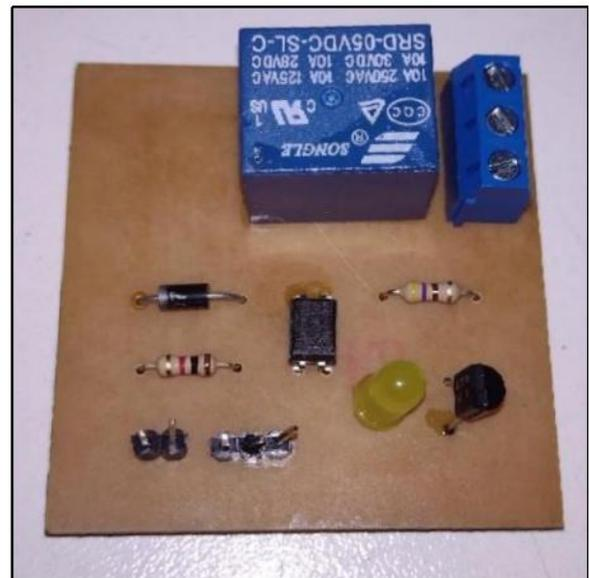
Fig. 2 b: Relé optoacoplado GAX1- Componentes
