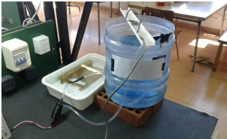
Figura 10. Bomba, tanque y sensor de ultrasonido.
