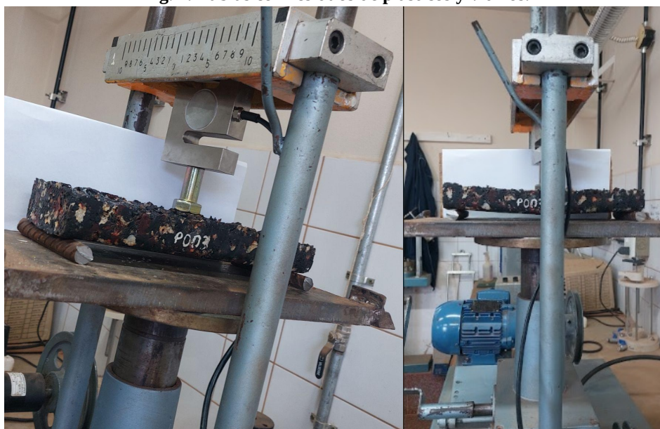
Fig. 2. Ensayo a flexión de los prototipos.
