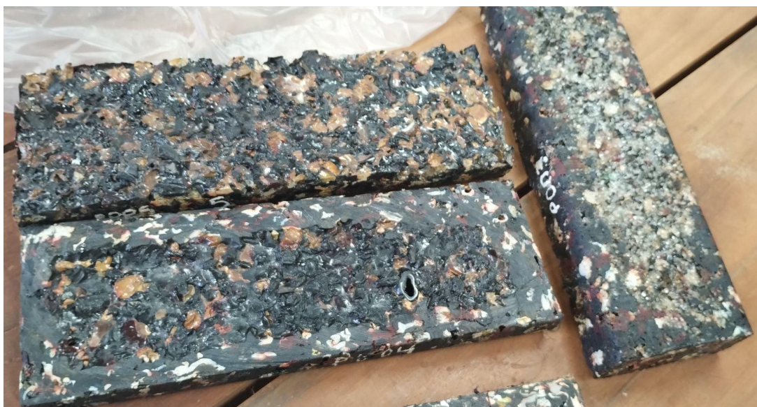
Fig. 1. Tablas con residuos de plásticos y vidrios.
