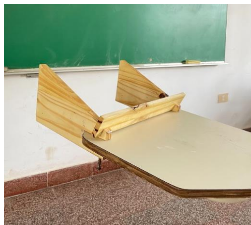
Fig.4. Prototipo desplegado sobre pupitre A1: se observa el soporte inclinado para notebook y la extensión de superficie.
