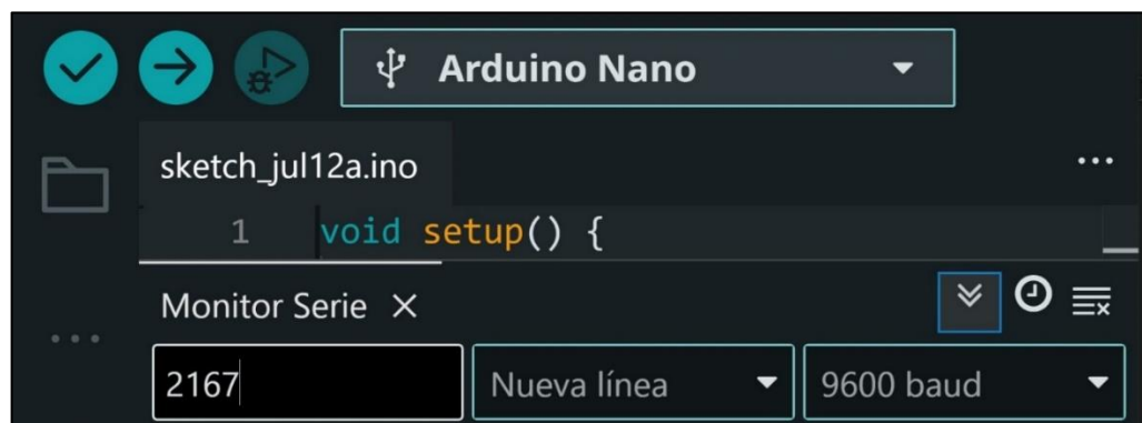
Fig. 8. Pantalla del monitor serie del IDE Arduino, con valor del ciclo útil enviado por la computadora a la interfaz PWM (Dato = 2167, equivalente a D = 21,67 %).
