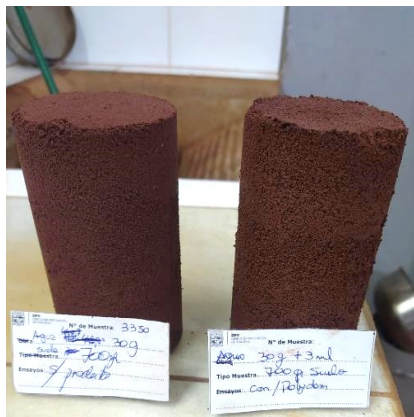
Muestras recién moldeadas sin inmersión en agua. Densidad: 1,40 gr/cm 3
