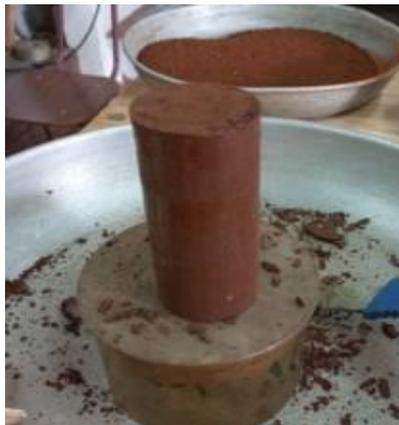
**Fig. 1. Probeta compactada a densidad y humedad controlada según ensayo Proctor.**
