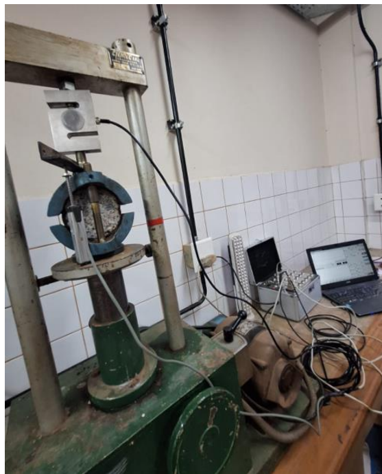
Fig. 2. Equipamiento para realizar el ensayo Marshall.
