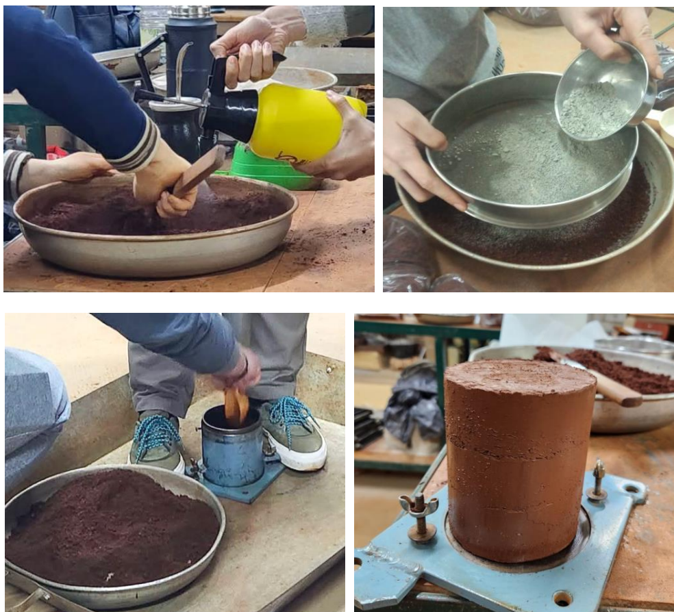
Fig. 1. Imágenes Fotográficas del procedimiento de moldeo en laboratorio.
