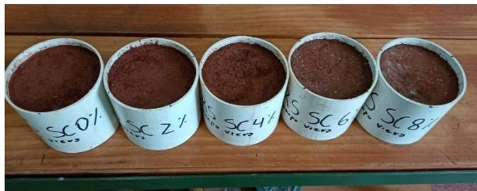
**Fig. 2. Probetas moldeadas a diferentes porcentajes de cemento añadido en rama seca.**
