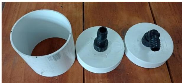
**Fig. 1. Permeámetro de PVC.**
