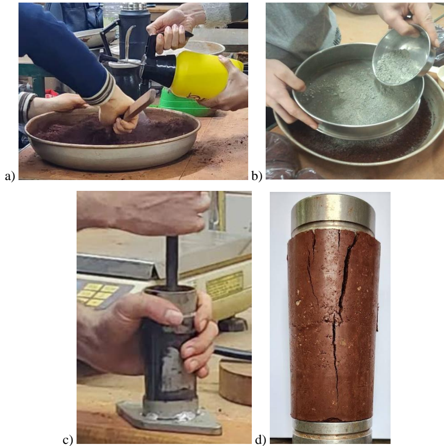
Fig. 1. Imágenes Fotográficas del procedimiento de moldeo en laboratorio.
