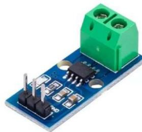
**Fig. 5. Sensor de corriente ACS712.**
