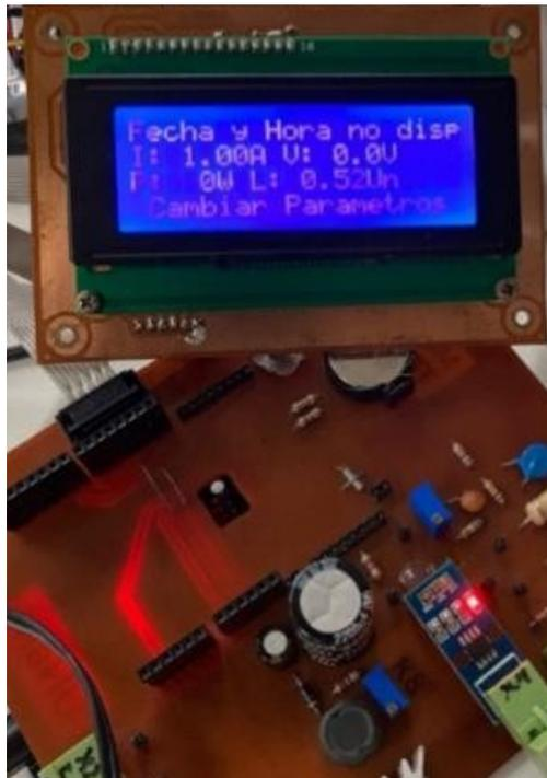
**Fig. 17. Verificación del funcionamiento del sensado de corriente.**
