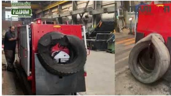
**Fig. 9. Destalonado de neumático usado (8)**
