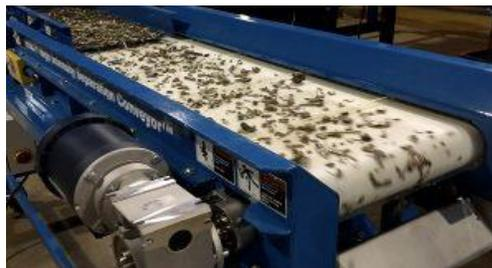
**Fig. 11. Separación de componentes del neumático (10)**
