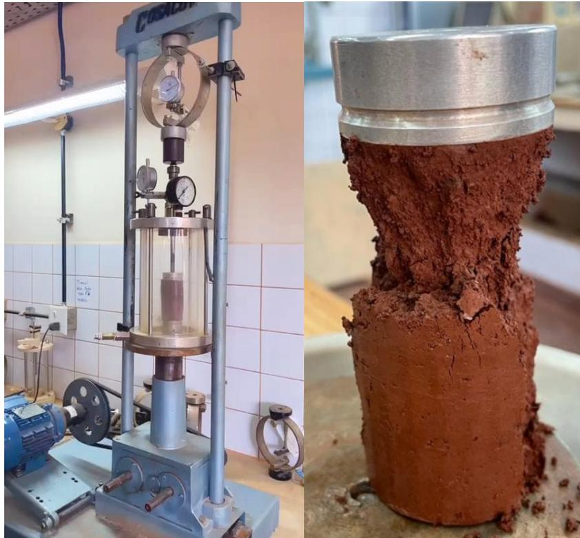
**Fig. 1.** Izquierda: Prensa Triaxial equipada (Laboratorio de Ingeniería Civil Facultad de Ingeniería UNaM). Derecha: Probeta de suelo cemento compactada y ensayada.
