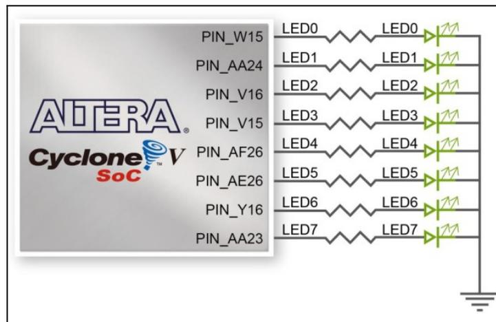
**Fig. 14. Conexiones entre los LED y el FPGA.**
