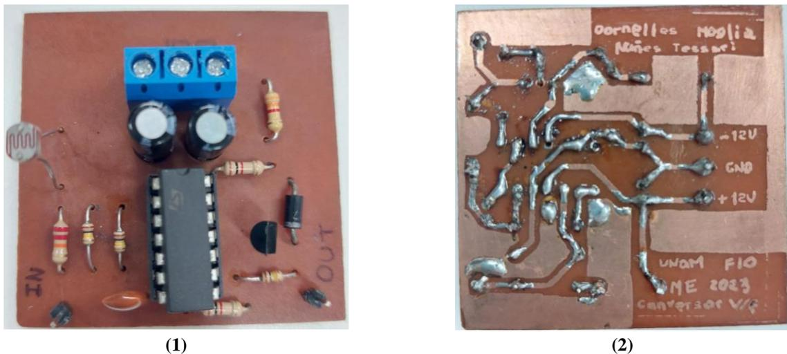
Fig. 9. PCB con todos los componentes soldados. (1) vista superior. (2) vista inferior.
