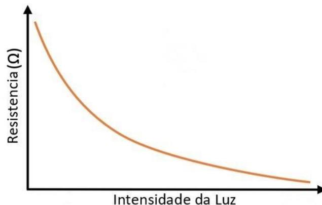
**Fig. 2. Variación de resistencia con la intensidad de luz de LDR.**
