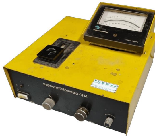
Fig. 2. Espectrofotómetro Crudo Caamaño Mod. 414 de simple haz.
