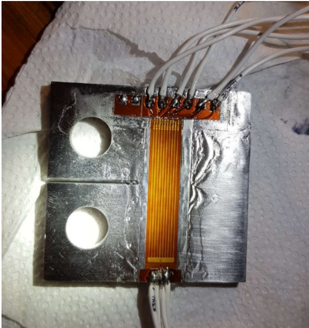
Fig. 10. Probeta instrumentada. con conexionado.
