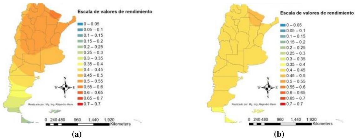
**Fig. 5. Comparativa de Rendimiento Térmico en Diferentes Puntos de Argentina de los Colectores. (a) Tipo Placa Plana. (b) Tubos de Vacío [11].**
