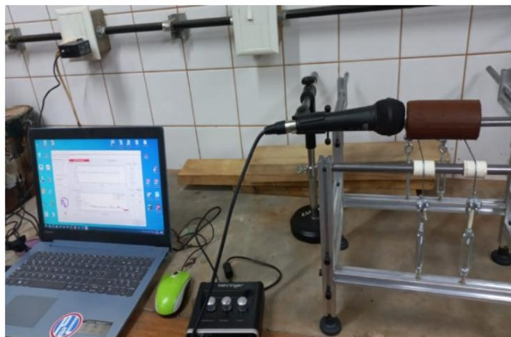
**Fig 2.** Ensayo de Emisión acústica, montaje del equipamiento empleado.
