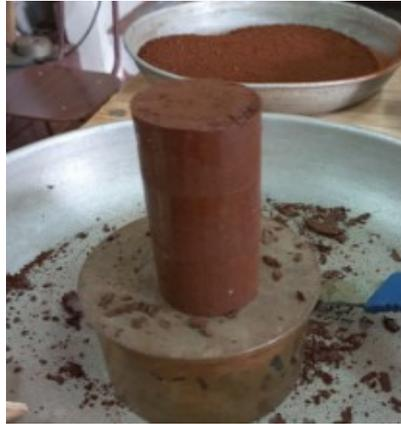
**Fig. 1.** Probeta compactada a densidad y humedad controlada según ensayo Próctor.
