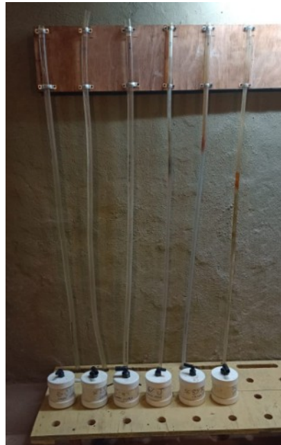
Fig. 2 Banco de ensayos de permeabilidad con los seis permeámetros de la muestra FI-002
