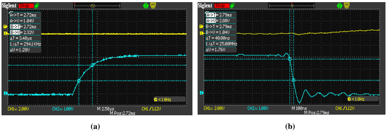
Fig. 3. Capturas de la señal SCL (azul): (a) Tiempo de subida; (b) Tiempo de bajada.
