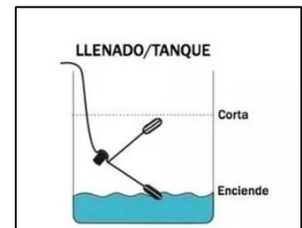
**Fig. 3. Funcionamiento del sensor de nivel flotador.**
