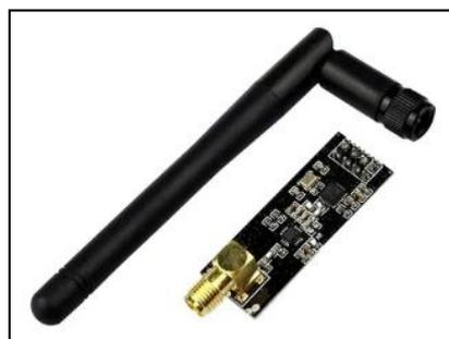
Fig. 7. Módulo transceptor nRF24L01.
