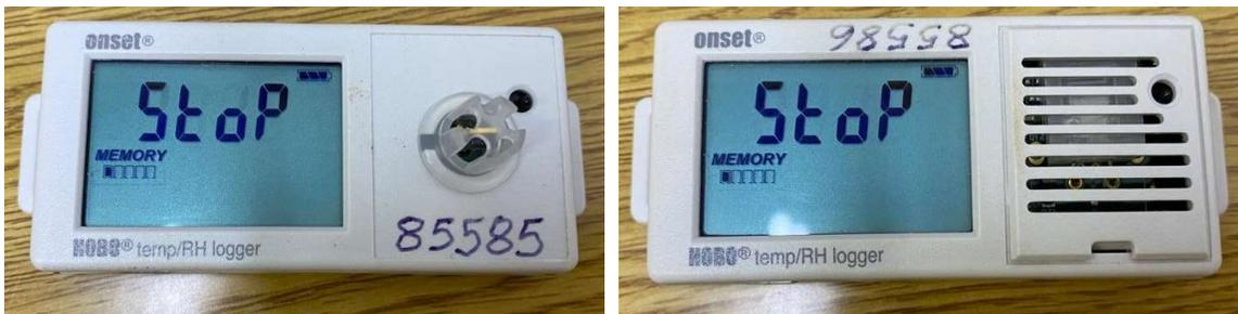
Fig. 1. Dispositivos HOBO para medición en interior.
