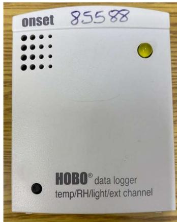
**Fig. 2. Dispositivo HOBO para medición en exterior.**
