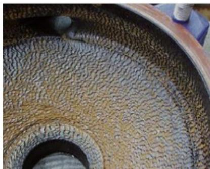
**Foto 03: Aspecto de la corrosión en carcasa de BC**
