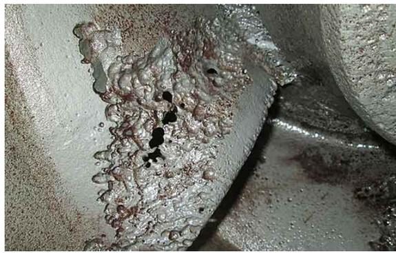
**Foto 02: Aspecto de la erosión por desgaste de partículas solidas**
