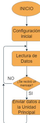
**Fig. 10. Diagrama de flujo del firmware para las unidades remotas.**
