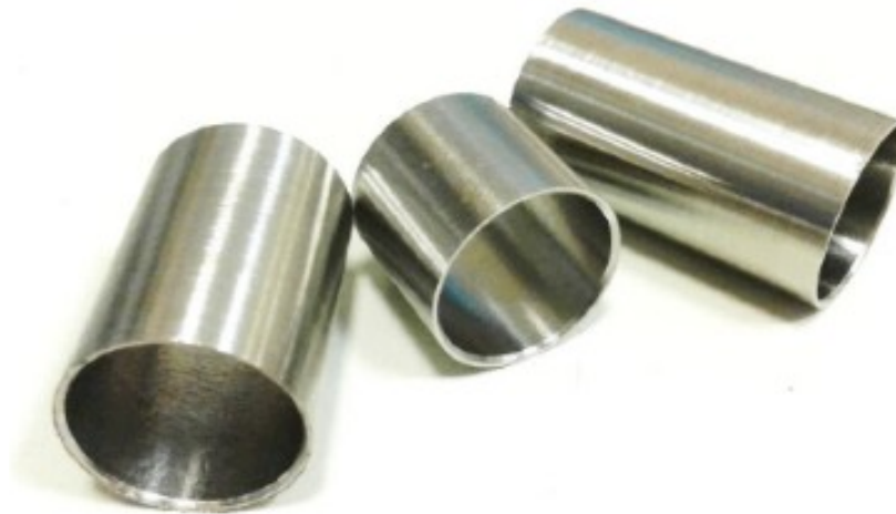
Fig. 9. Acoples sin costura fabricados por el grupo de trabajo mediante extrusión por punzonado en caliente [32].
