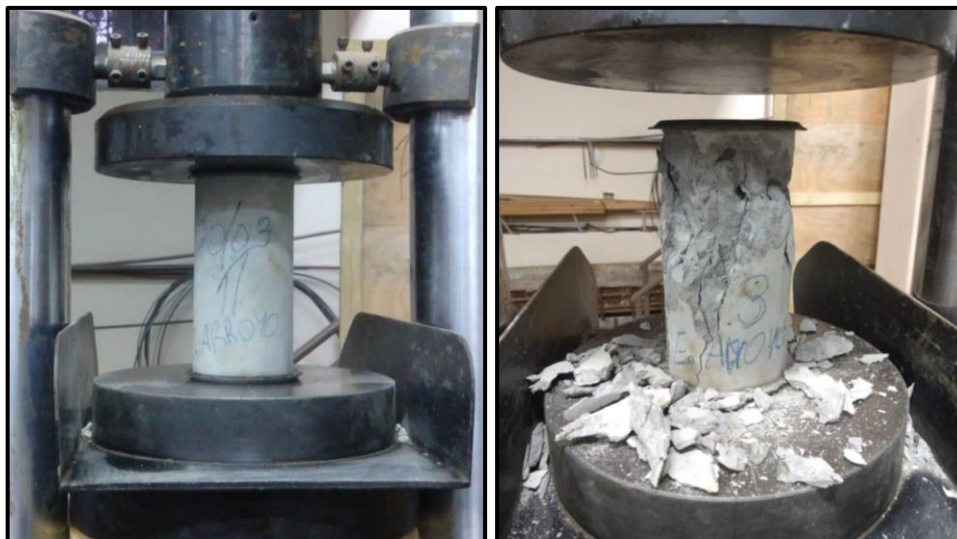
Fig 3. Probeta 1, antes y después del ensayo a compresión.
