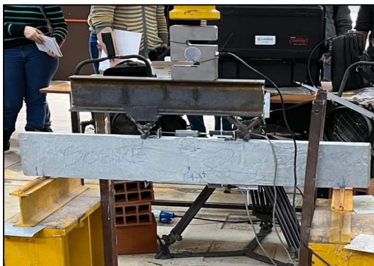
Fig 4. Disposición de viga para el ensayo.
