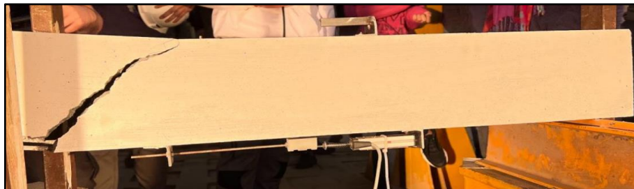
Fig 7. Falla viga Sub-Armada sin armadura a corte - V01. Vista frontal.
