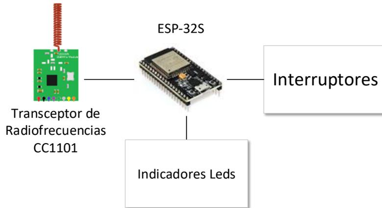
**Figura 4: Esquema de conexión Tablero.**
