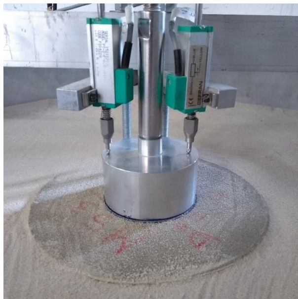
Fig. 4. Ensayo en modelo reducido de zapata y capa de refuerzo.
