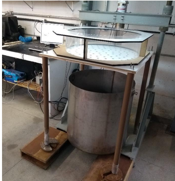
Fig. 3. Elemento para el llenado del tanque con suelo en estado suelto.
