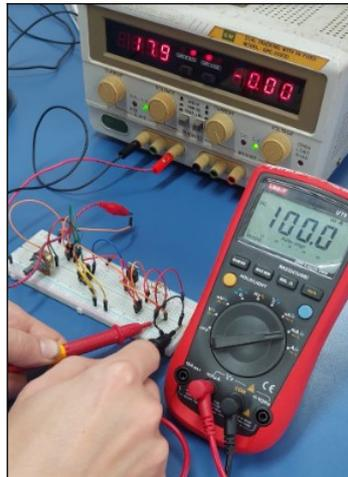
**Fig. 7. Medición de corriente.**
