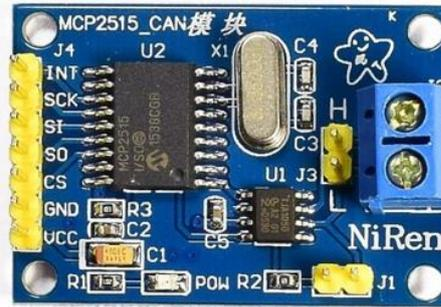
**Fig. 2. Módulo para comunicación con protocolo CAN.**
