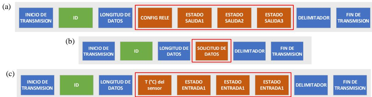
**Fig. 6. Trama de datos CAN para: (a) Configuración de salidas; (b) Solicitud de datos; (c) Recepción de datos.**
