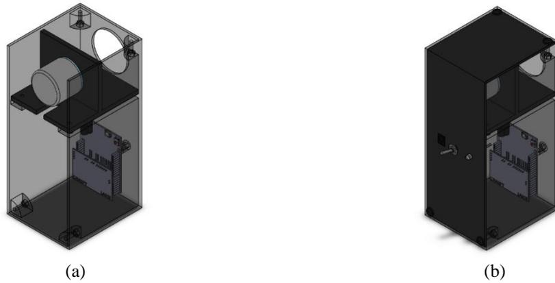
Fig. 10. Modelación 3D del montaje de componentes en el gabinete del sistema de adquisición local.
