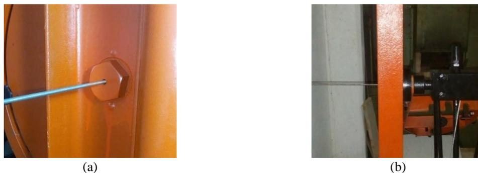
Fig. 7. Varilla roscada conectada al eje de rotación del péndulo.
