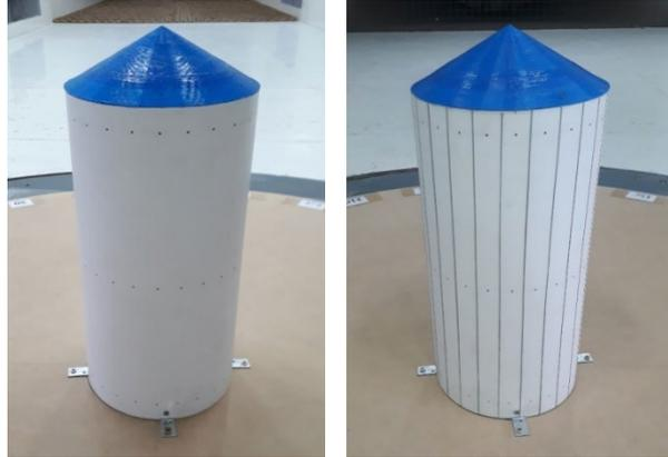
**Fig. 2: Modelo de silo aislado instrumentado con y sin rugosidad montado en la cámara de ensayos.**
