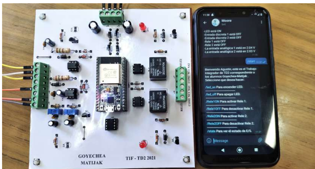
Fig 13. Circuito final en funcionamiento junto al chat del bot.
