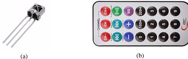
Fig. 3. (a) Receptor infrarrojo AX-1838HS; (b) Control remoto.
