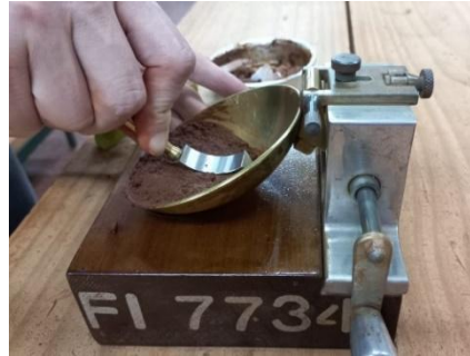
Fig. 2. Cascador de Casagrande con muestra de suelo.
