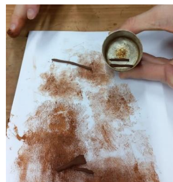
Fig. 5. Confección de cilindros para ensayo de LP.
