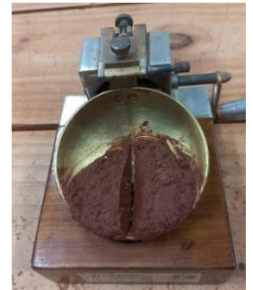
Fig. 3. Cascador de Casagrande con muestra de suelo.
