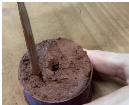
Fig. 11. Extracción de muestra de suelo.
