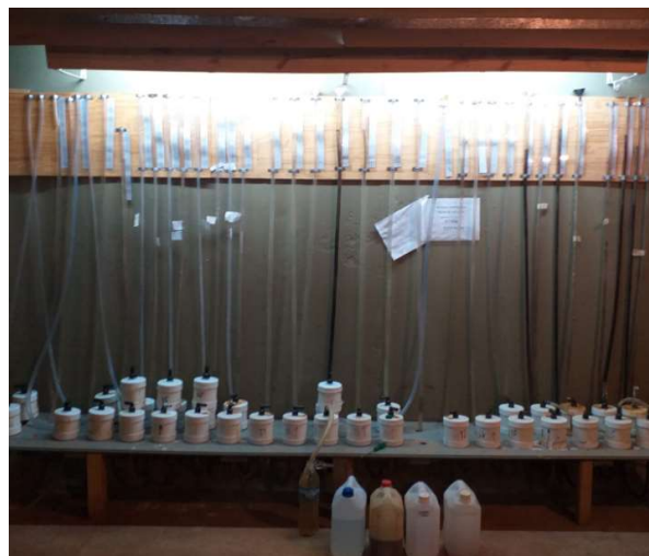
ENSAYO DE CONDUCTIVIDAD HIDRÁULICA MUESTRA: FI010 [ML] - FLUIDO: AGUA
