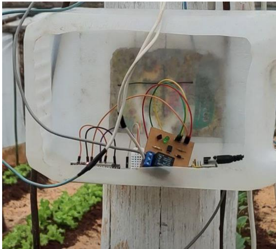
Figura 2. Microcontrolador cliente dentro del invernadero.
