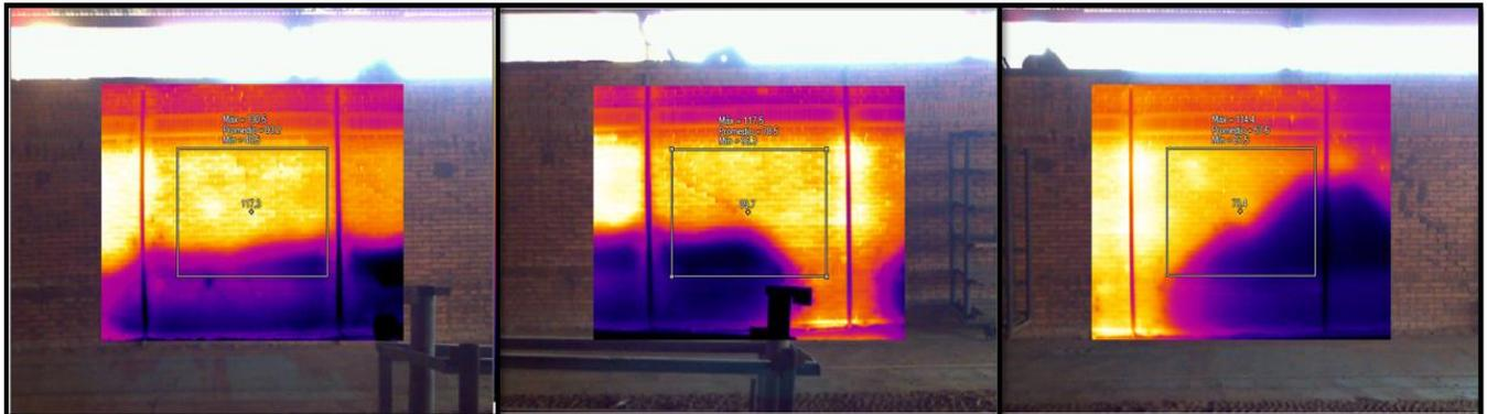
Figura 8- Imagen termográfica de una parte de la pared del horno de cocción.
