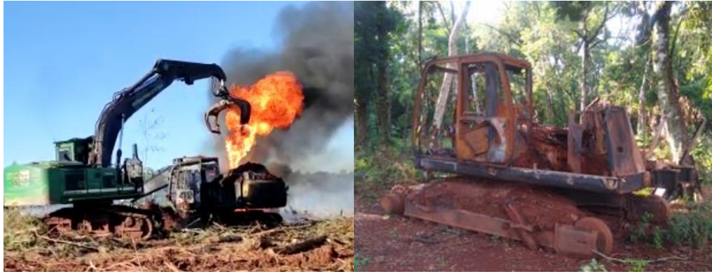
Fig. 3- Incendio de una máquina forestal.
