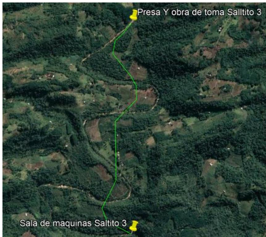
**Fig. 4. Trazado Tubería Forzada [1].**
