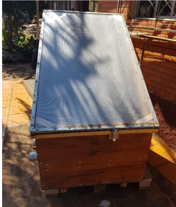
Fig. 3. Prototipo secador solar vista anterior
