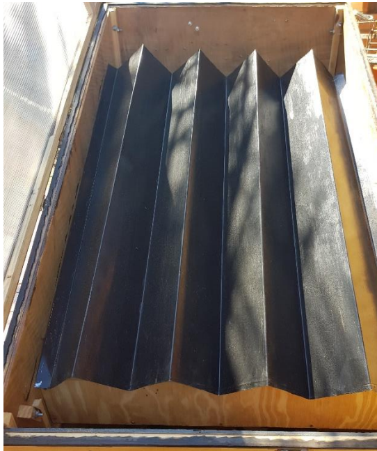
Fig. 5. Prototipo secador solar. Colector.
