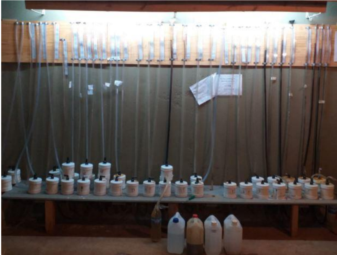
Figura 6: Banco de ensayos. Foto de Permeámetros (Agua y Lixiviado)
