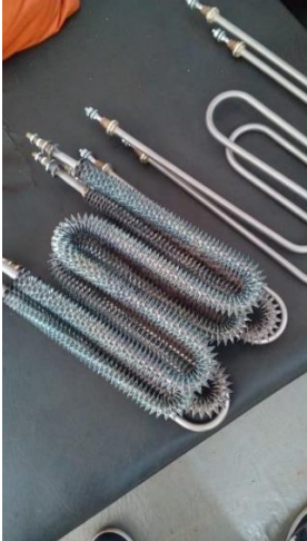
Fig. 2. Resistencias en forma de M adquiridas para el prototipo.
