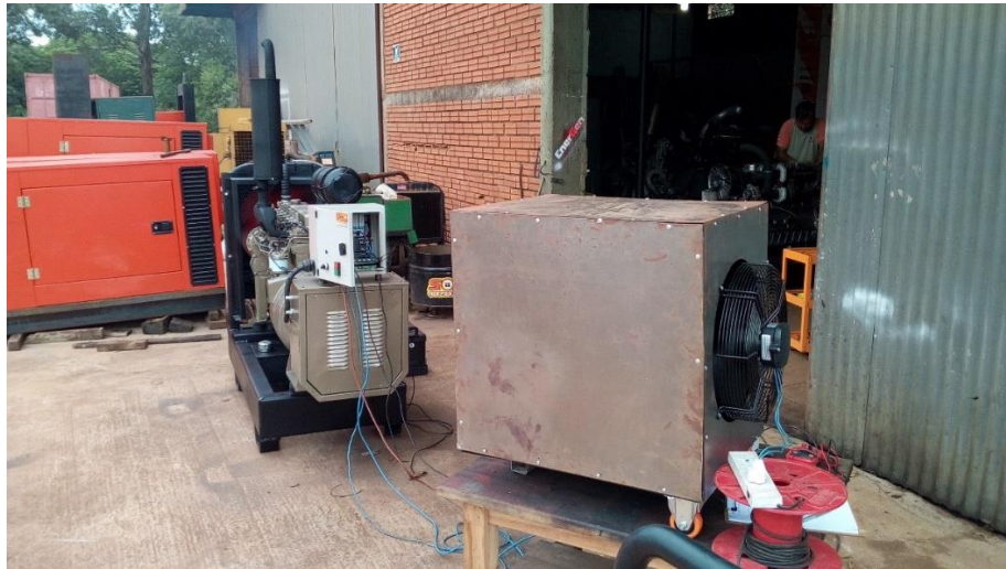
Fig. 11. El banco de cargas durante una de las pruebas en las instalaciones de la empresa.
