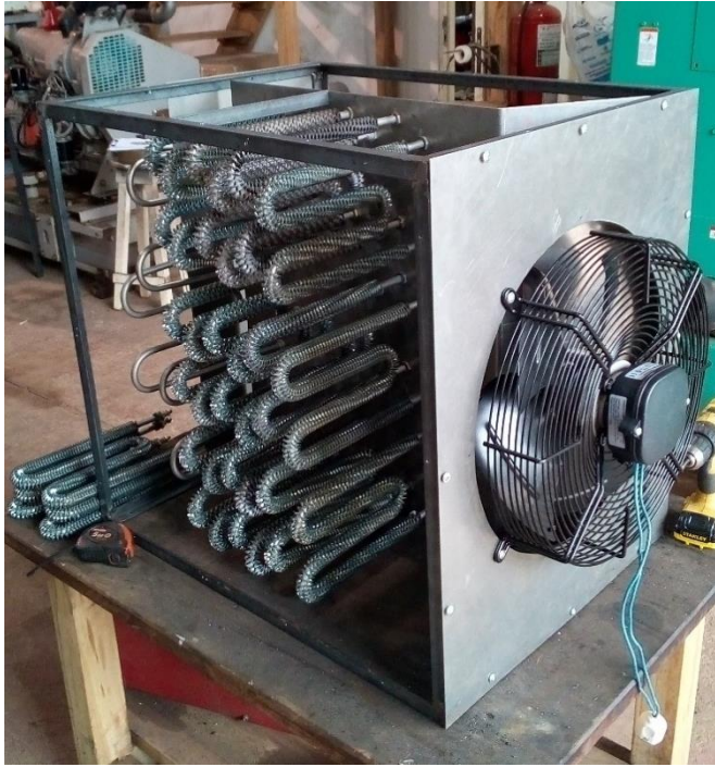
Fig. 9. Instalación de las resistencias en el banco.
