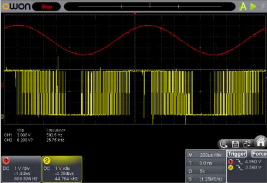
Fig.7: Medición de señal senoidal de 500 Hz (CH1) y señal PWM en el pin OC5B (CH2).
