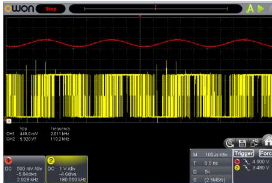
Fig.8: Medición de señal senoidal de 2000 Hz (CH1) y señal PWM en el pin OC5B (CH2).
