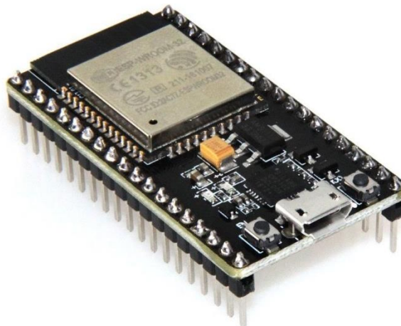
Fig. 2. Placa de desarrollo HiLetgo ESP-32S.
