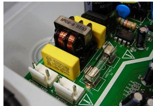
**Fig. 12. Otra vista de capacitores tipo X en un filtro (EMI-EMC) diferencial de simple paso, montados en una placa de circuitos impreso de una fuente de alimentación.**
