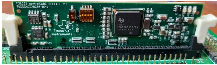
Fig. 8. Tarjeta de control que contiene el microcontrolador de alto rendimiento.
